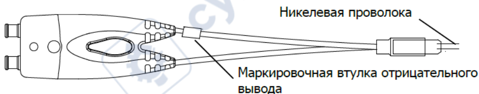
Рисунок 8 - Припаиваемая несимметричная измерительная головка
