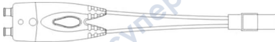
Рисунок 9 - Дифференциальная измерительная головка с гнездовым разъёмом
