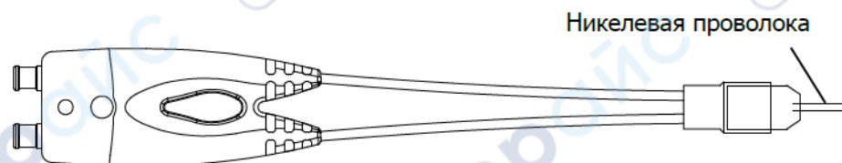
Рисунок 7 - Припаиваемая дифференциальная измерительная головка
