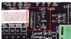
Переключатель замыкает контакты [MVCC->5V] (установлена по умолчанию на заводе-изготовителе)
