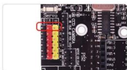
Контакты для подключения серводвигателя [J1]. Коричневый провод подключается к контакту GND (земельное), красный — к контакту VCC, оранжевый — к контакту IO.
