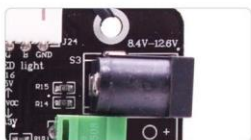
[8,4В-12,6В]: Разъем для зарядки литиевых аккумуляторов типа 18650. Обратите внимание, что разъем постоянного тока находится на плате расширения.
