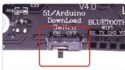
При загрузке кода переведите выключатель в положение ON (вкл.). При использовании модуля Bluetooth / Wi-Fi переведите его в положение OFF (выкл.).
