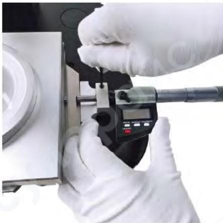
Установка микрометра по оси X:
