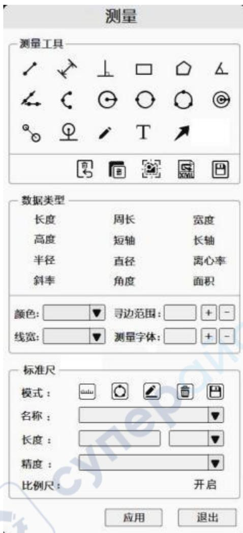
测量图形根据测量需要，对应选取相应图标后，进入预览界面，根据要求选取相应位置实现测量功能，相机系统可以对所测量的图形进行移动、选中删除、全部删除、截屏、导出坐标参数等功能。
