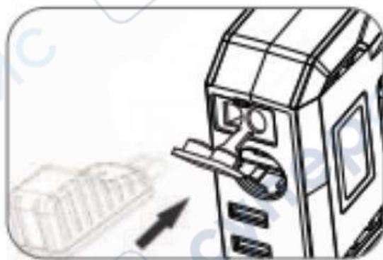
Шаг 2: Подсоедините красный зажим к положительной клемме (+) автомобильного аккумулятора, а черный зажим — к отрицательной клемме (-) автомобильного аккумулятора. Если зеленый и красный световые индикаторы на зажиме аккумулятора мигают попеременно, вы можете смело переходить к следующему шагу.
