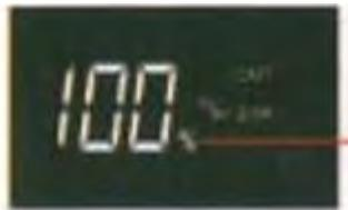
1. Во время процесса зарядки устройства на цифровом дисплее отображается значение мощности. Значение, отображаемое на дисплее мощности, представляет собой фактическую мощность устройства, когда значение мощности показывает 100%, это означает, что зарядка приостановлена или завершена.
