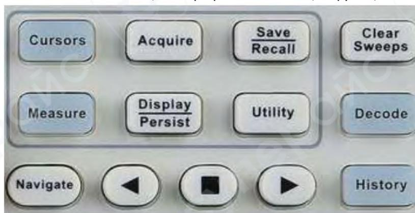
4-канальный осциллограф - панель общих функций
