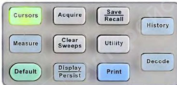
2-канальный осциллограф - панель общих функций
