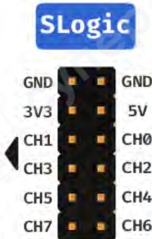
На диаграмме выше показана распиновка для 8 каналов SLogic. Подключите тестовые точки сигнала целевого устройства к любому доступному порту CH на SLogic. Убедитесь, что заземление целевого устройства соединено с заземлением SLogic.
