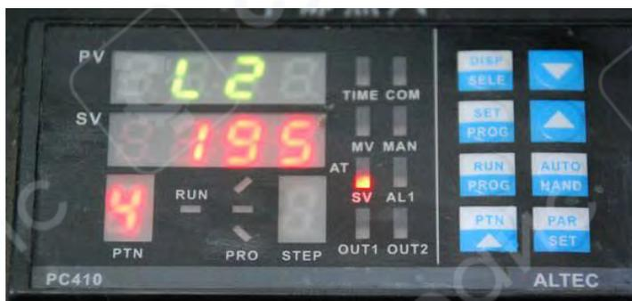
7) Настройте время удержания заданной температуры  $195\text{ }^{\circ}\text{C}$  второго участка кривой  $D2 = 40$  (поддерживать  $195\text{ }^{\circ}\text{C}$  в течение 40 секунд). Нажмите PAR.
