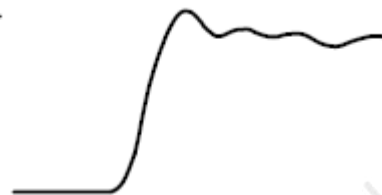
Вид сигнала с длинным проводом заземления
