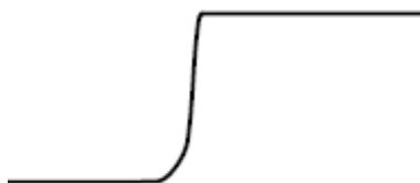
Вид сигнала с коротким проводом заземления
