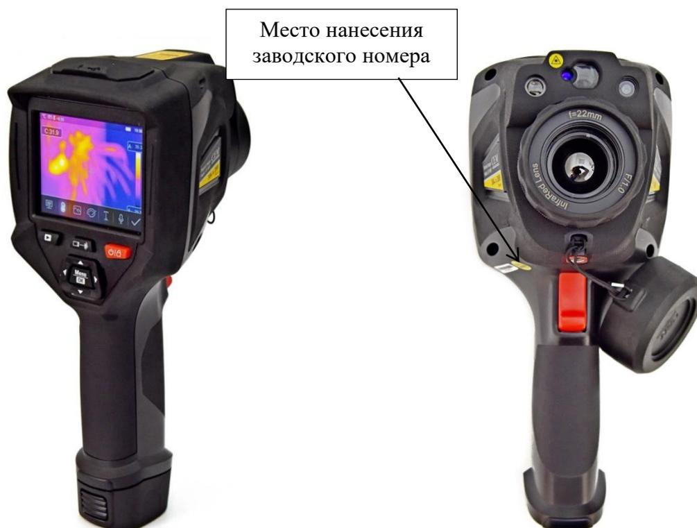
Рисунок 1 – Общий вид тепловизоров инфракрасных СЕМ DT моделей DT-9897, DT-9897H
