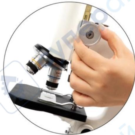
4. Поворачивайте револьверное гнездо, выбирая нужный объектив. Объектив должен быть установлен строго вертикально по отношению к препарату.
