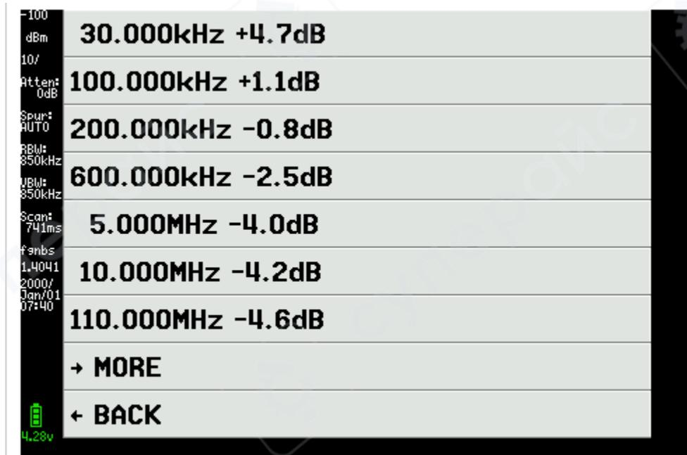
После выбора конкретной записи (например, 10 МГц), tinySA начинает генерировать сигнал 10 МГц с уровнем примерно -35 dBm, и подключённый селективный измеритель
