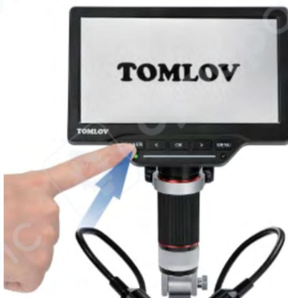
3) При необходимости отрегулируйте высоту микроскопа. Чем ближе микроскоп к объекту наблюдения, тем больше кратность увеличения. После регулирования высоты, необходимо использовать регулятор фокусировки, чтобы улучшить четкость и качество изображения.
