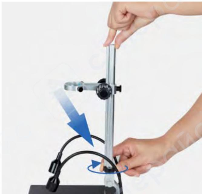
4. Полностью опустите микроскоп и закрутите фиксирующий винт.
