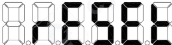
При отображении указанного экрана: нажмите клавишу Enter, чтобы сбросить параметры прибора к значениям по умолчанию и перейти в режим тестирования.
