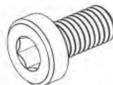
Винт с цилиндрической головкой M3\*6 x 4
