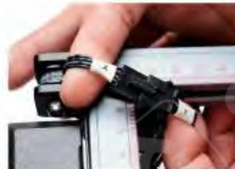
Y(4PIN) → Кабель шагового двигателя по оси Y
