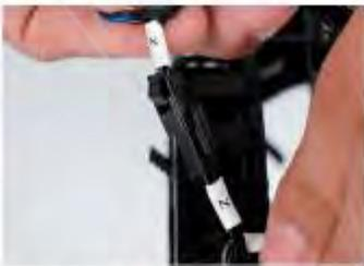
Z(2PIN) → Кабель концевого выключателя по оси Z
