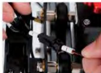
I(2PIN) → Линия вентилятора лазера
