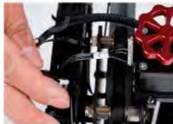
Z(4PIN) → Кабель шагового двигателя по оси Z
