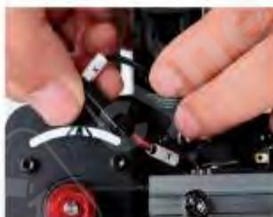
X(2PIN) → Кабель концевого выключателя по оси X
