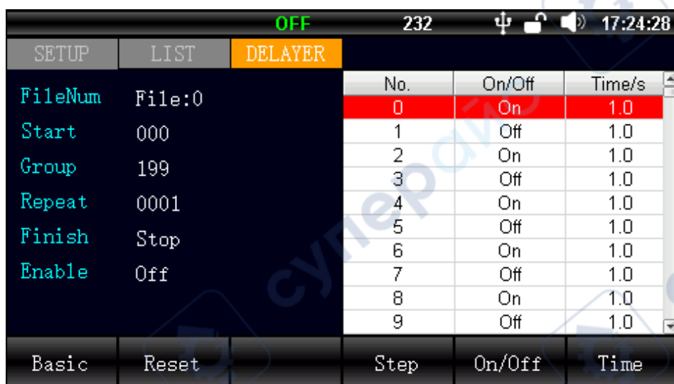
Настройка параметров выхода Delayer
