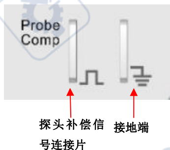
图 4-1 探头补偿信号连接片和接地端
