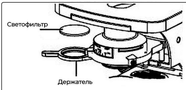
Сдвиньте держатель светофильтров под влево, выдвинув его из оптического пути.
