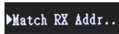
MDP-M01与MDP-P906配对时才能启动自动匹配无线地址功能，匹配方法请参考《MDP-M01智能数字显示器用户手册》"四、CONFIG界面"。当进行无线地址匹配时，如果电源输出已打开，基于安全考虑，电源输出将会被强制关闭。
