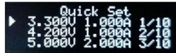
【3.4.1】按住SET键，并同时短按MENU键进入快速设置电压电流菜单。使用拨轮循环切换预设值，按SET键选择相应预设值输出并切换到运行状态界面。无选择或选择超时将自动退出，也可单击MENU键退出。
