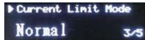
适用条件：当输出电流设置为10A、电源仍无法满足负载正常启动时，可尝试使用“Unlimited”强力模式。
