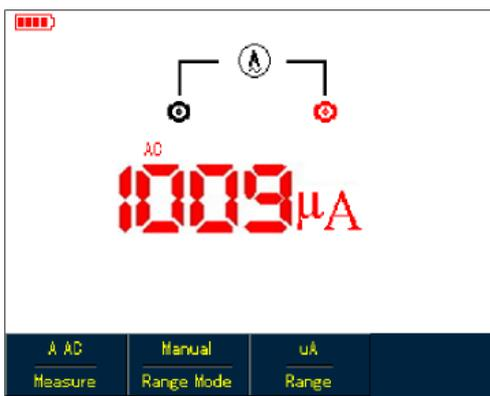
Рисунок 5-17. Измерение переменного тока до 1 мА (UTD1000DL)
