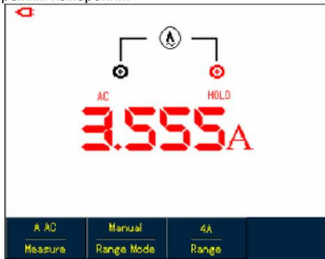
Рисунок 5-21. Фиксация показания дисплея
