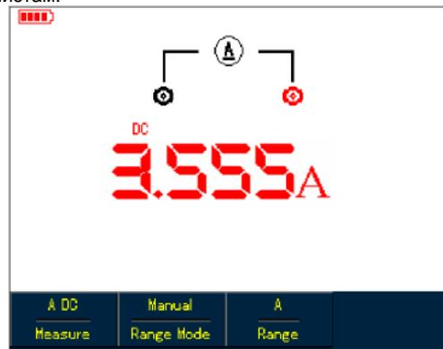
Рисунок 5-9. Измерение постоянного тока более 400 мА (UTD1000CL)
