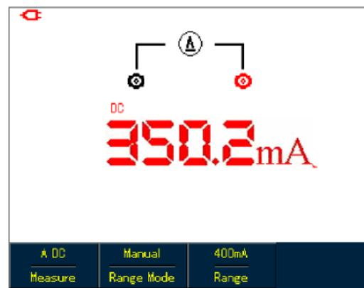
Рисунок 5-15. Измерение постоянного тока от 40 до 400 мА (UTD1000DL)
