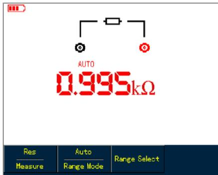
Рисунок 5-1. Измерение сопротивления
