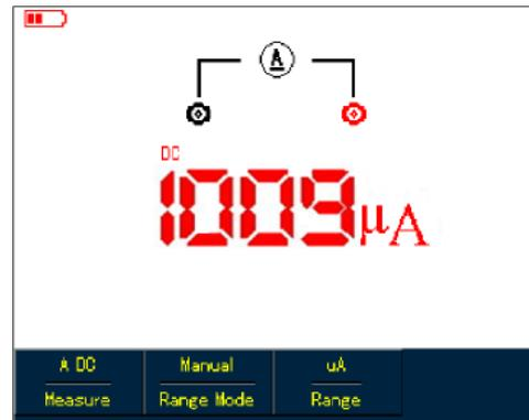
Рисунок 5-13. Измерение постоянного тока до 1 мА (UTD1000DL)
