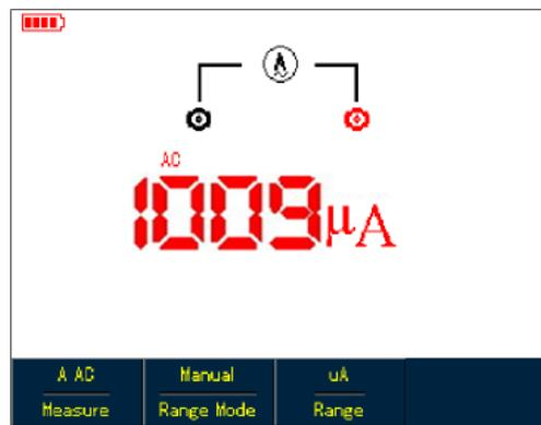
Рисунок 5-10. Измерение переменного тока до 4 мА (UTD1000CL)
