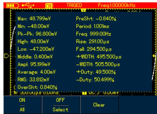
Рисунок 6-16(a). Измерение полного набора параметров в модели UTD1000CL
