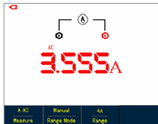
Рисунок 5-20. Измерение переменного тока более 400 мА (UTD1000DL)
