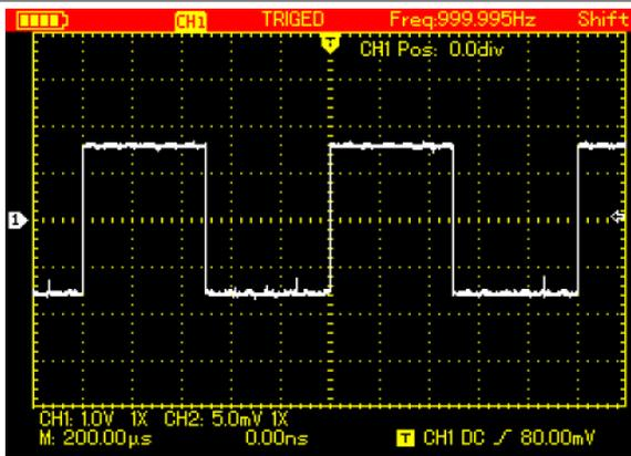
Рисунок 4-19. Построение осциллограммы в режиме обнаружения пиков
