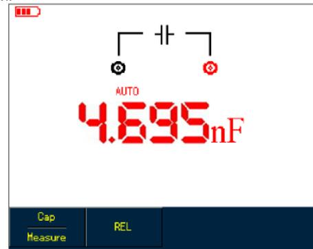
Рисунок 5-4. Измерение емкости
