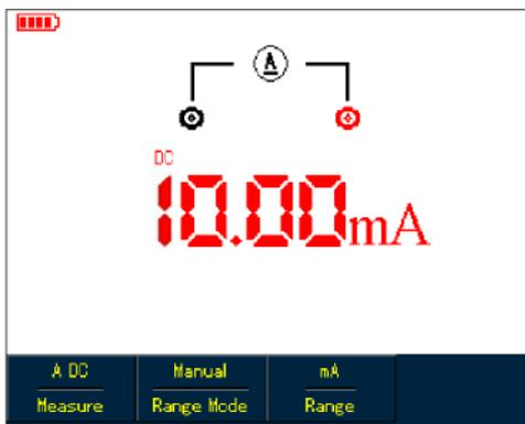
Рисунок 5-8. Измерение постоянного тока до 400 мА (UTD1000CL)
