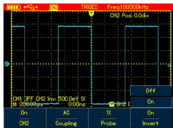
Рисунок 4-23(б). Обращенная осциллограмма (модель UTD1000DL)
