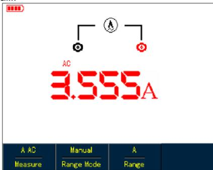
Рисунок 5-12. Измерение переменного тока более 400 мА (UTD1000CL)
