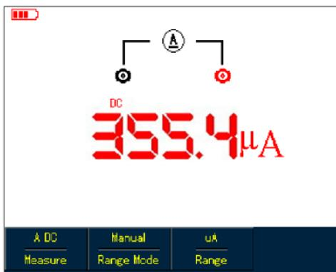
Рисунок 5-7. Измерение постоянного тока до 4 мА (UTD1000CL)
