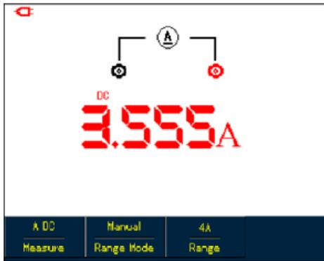
Рисунок 5-16. Измерение постоянного тока более 400 мА (UTD1000DL)
