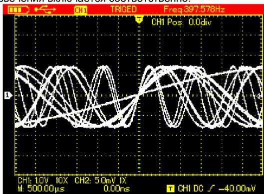
Рисунок 4-21. Послесвечение дисплея, установленное на 3 с
