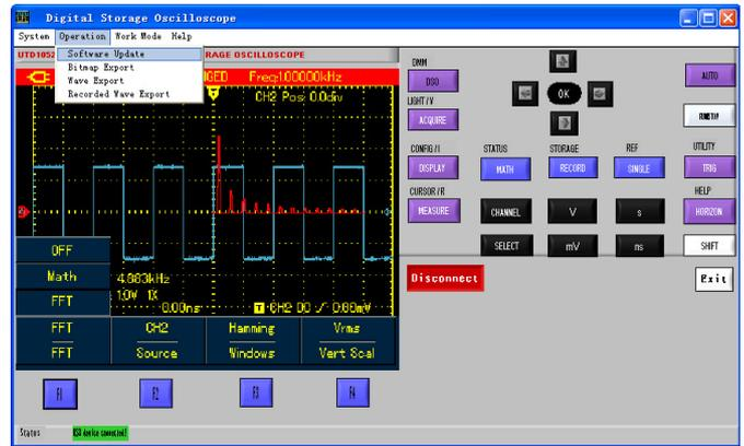
Рисунок 8-2. Обновление прошивки осциллографа
