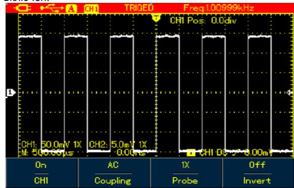
Рисунок 4-11. Частотомер пускового сигнала в модели UTD1000CL
