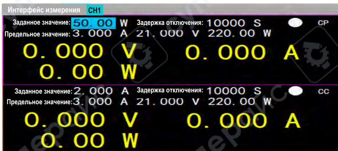
Рисунок 10 — Режим измерения постоянной мощности
