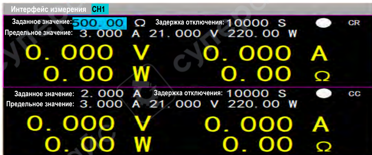
Рисунок 9 — Режим измерения постоянного сопротивления
