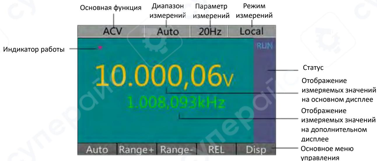
**Описание:** На рисунке изображен интерфейс при измерении переменного напряжения. Основной дисплей отображает значение напряжения, а вспомогательный дисплей - значение частоты.
