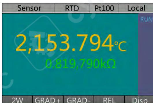
**Описание:** Основное отображаемое значение показывает измеренную температуру, а вспомогательное значение отображает соответствующее сопротивление.
