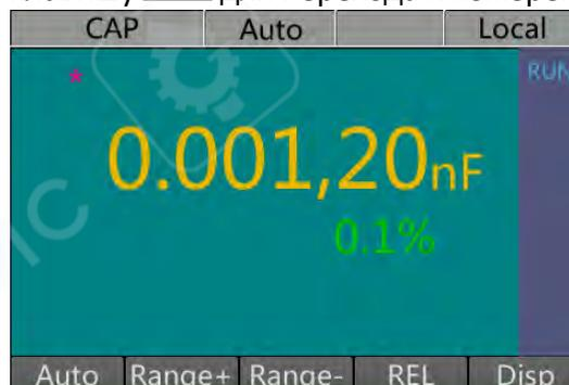
**Описание:** Основное отображаемое значение показывает измеренное значение емкости, а дополнительное значение отображает отношение между измеренным значением и полным диапазоном измерений.
