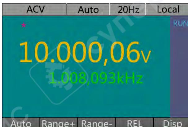
**Описание:** Основное отображаемое значение показывает измеренное напряжение, а дополнительное значение отображает частоту входного сигнала.
