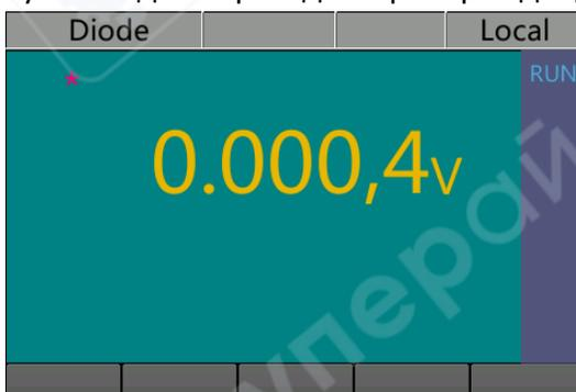
**Описание:** При значении напряжения выше порога измерения отображается "OPEN", в противном случае отображается фактическое значение напряжения.
