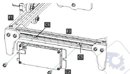
19. Установить блок управления сзади на профиле F3
