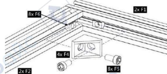
12. Соедините F1 и F3 с F4 и F5. Следите за сборкой всех деталей в единой плоскости рамки. Рекомендуется сначала установить все углы F4 и винты F5. Затем уложить рамку ровно на плоской поверхности и затянуть все винты окончательно.
