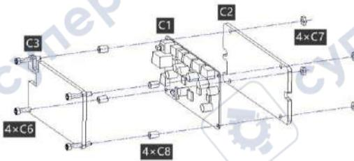
18. Сборка платы управления C1 с пластинаами C2, C3. Этот узел называется **блок управления**.
