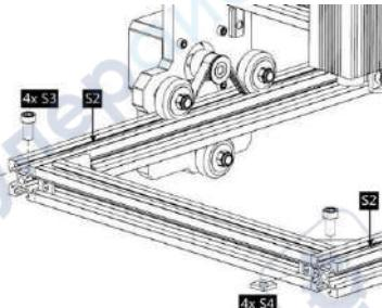
16. Сперва закрепите S2 в начальной точке с помощью S4 и N2. Затем натяните ремень и закрепите его на другом конце с помощью S4 и N2.
