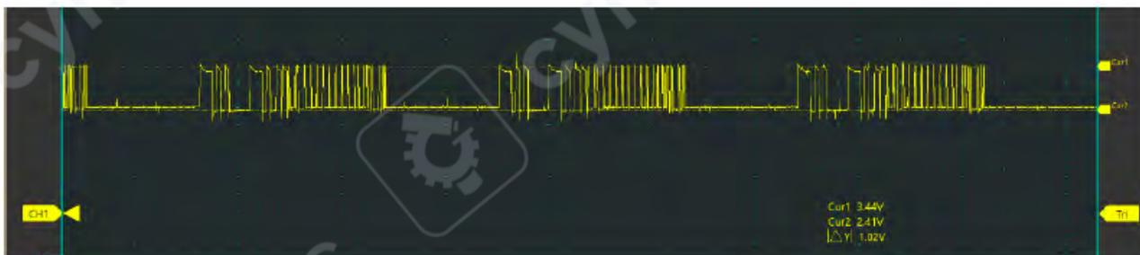
**Пример:** Сигнал шины **CAN**, полученный через канал CH1, имеет диапазон напряжений от 2,4 В до 3,4 В (по измерениям курсора). В этом случае:
