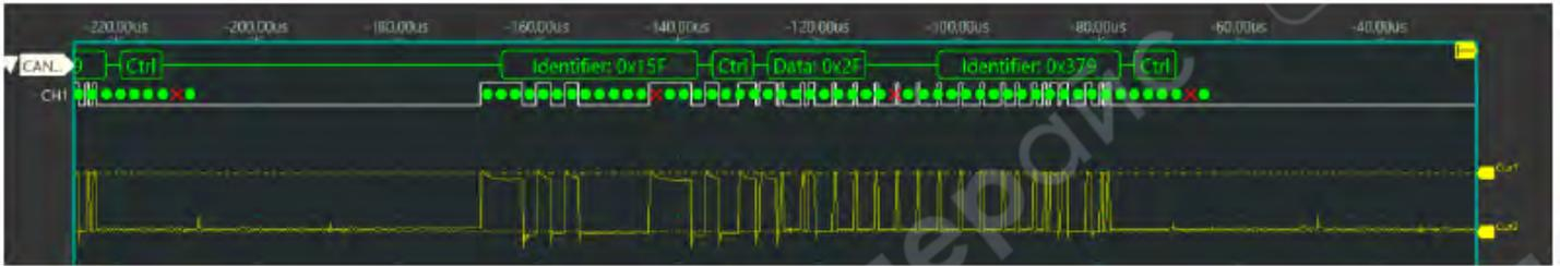
После корректировки параметров Threshold и Sensitivity цифровой сигнал CH1 в декодере будет успешно соответствовать высоким и низким уровням аналогового сигнала CH1. Это подтверждает правильность настроек, и декодер сможет корректно расшифровать информацию соответствующего протокола.
