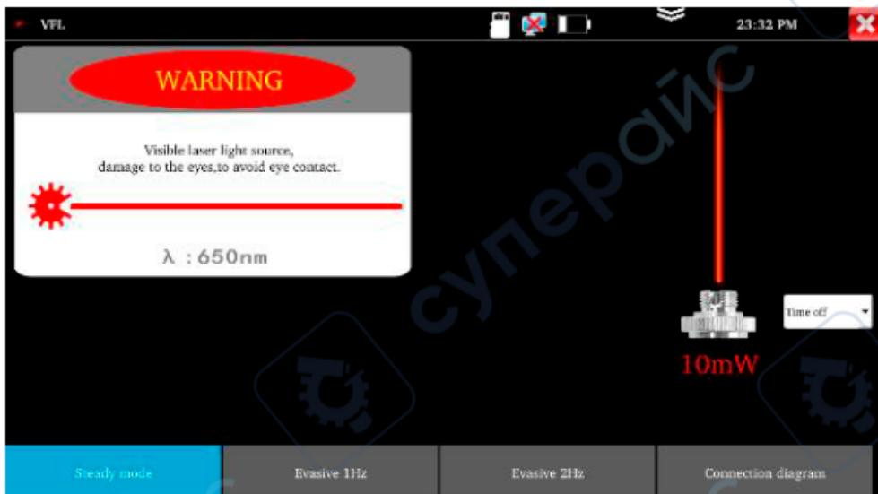
**Предупреждение:** не смотрите непосредственно в лазерный выходной порт — лазерное излучение может повредить глаза!
