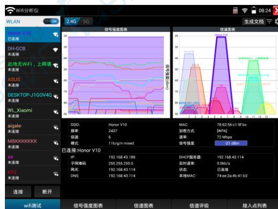
长按 WLAN 列表中的 SSID 号，可修改显示颜色。列表 SSID 号颜色使用默认预设颜色，预设颜色可在设置菜单中进行设置。
