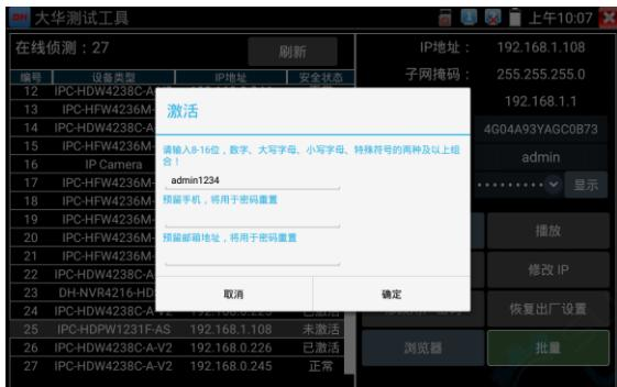
**播放：**安全状态显示“已激活”的摄像机，在右侧[密码]框中输入正确摄像机密码后，点击[播放]可显示摄像机图像，长按“播放”可选“私有协议”或“极速 ONVIF”观看摄像机图像。
