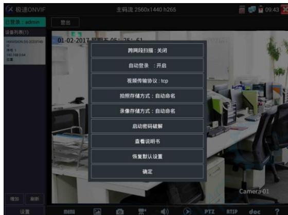
**跨网段扫描：**开启后，极速ONVIF可以跨网段搜索摄像机IP
