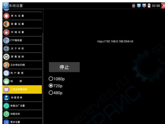
安卓手机安装“远程控制”APP，打开后点击“自动搜索IP”，出现“远程主机IP”时点击“播放”。此时手机将显示工程宝实时屏幕投影，可进行触屏控制工程宝。
