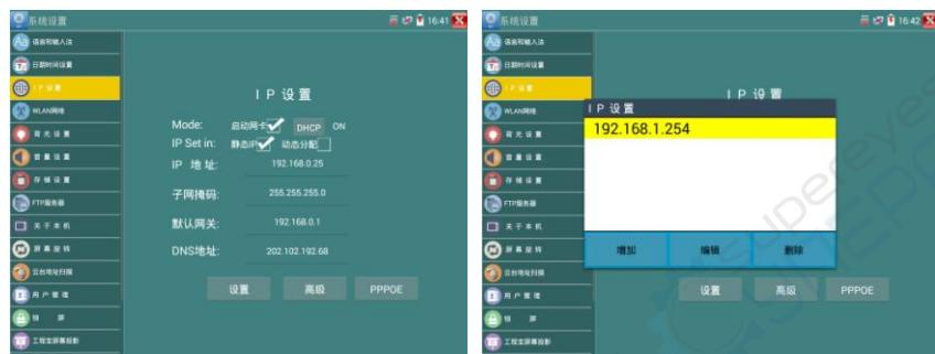
设置上图所示的IP地址后，仪表可以测试192.168.0.0和192.168.1.0两个网段的摄像机。
