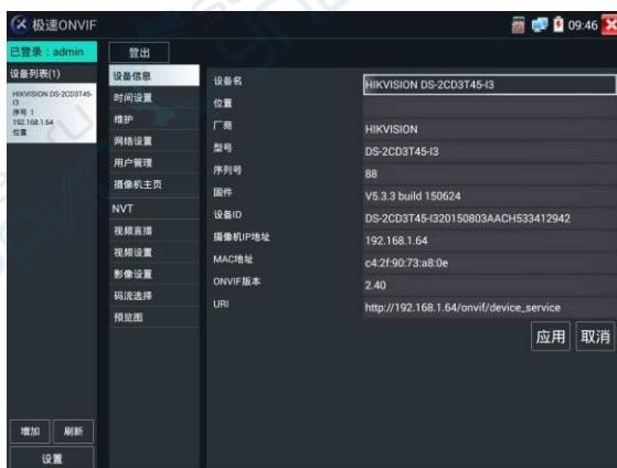
**时间设置：**点击“时间设置”，选择“手动设置”可对摄像机时间进行设置。
