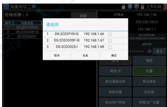
输入新的 IP 地址、子网掩码，默认网关将根据 IP 地址自动修改，点击“确定”保存修改。
