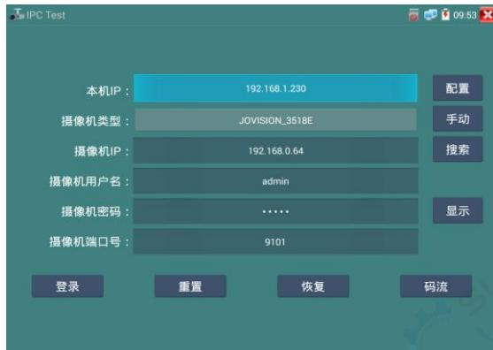
**本机IP：**指本仪表的IP地址，仪表支持多网段的IP摄像机测试。点“配置”，进入仪表系统设置的“IP设置”界面，设置本仪表的IP地址，可在高级选项中添加不同网段的IP地址，点“设置”保存，提示设置成功，点 关闭设置，返回到IPC Test界面。
