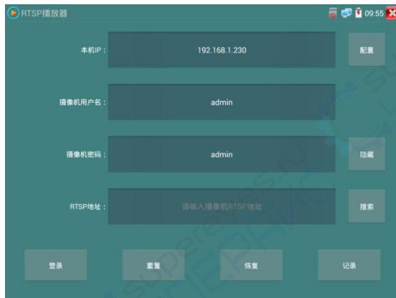
点击“RTSP 地址”后面的搜索，选中扫描到的摄像机的 IP 地址。仪表将扫描到网络摄像机的 RTSP 地址自动填入，客户也可以手动填入已知 RTSP 地址。
