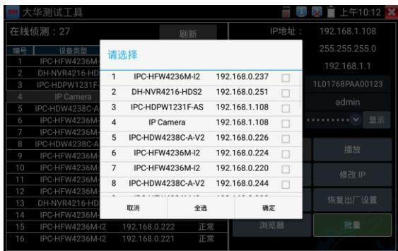
输入新的IP地址后，需要输入摄像机密码，点击“确定”保存修改。
