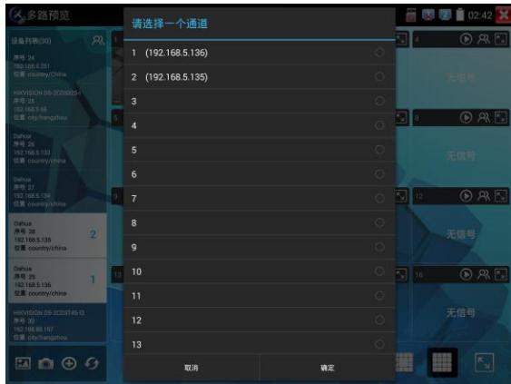
通道窗口上方图标依次为 ONVIF 链接、登陆窗口、全屏显示。当个别摄像机与全局密码不一致时，可点击通道窗口上方登陆图标进行单独通道的密码修改。
