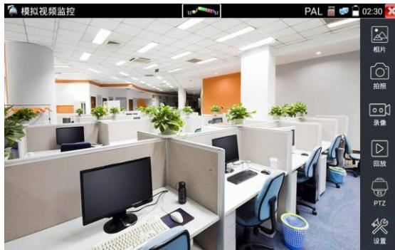
进入模拟视频监控测试界面，当有图像输入时，显示摄像机送过来的图像。在接收到摄像机或快球的图像时，可轻触上面菜单条的
