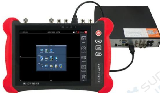
(1) 将硬盘录像机等设备的HDMI输出接口连接到IPC Tester视频监控测试仪顶部的HDMI输入端口，仪表的LCD屏幕将显示硬盘录像机等设备的输出图像；
