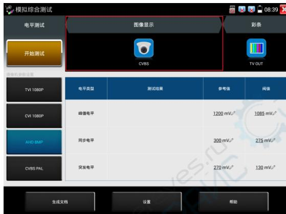
参数设置完成后，点击“开始测试”。仪表将实时检测并显示视频电平的峰值、同步和突发电平值。
