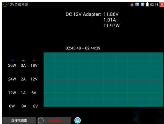
插拔电源适配器或电源适配器、摄像机工作不稳定时，曲线将出现明显的波动。
