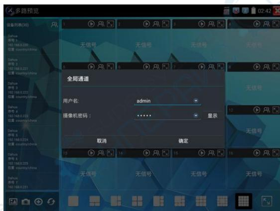
在左侧设备列表选中摄像机，选择一个通道打开摄像机。已经打开摄像机的通道，将显示摄像机 IP 地址。
