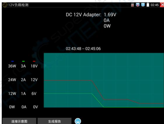
点击“生成报告”，“生成报告”按键上进度圈一直显示转动，此时将记录当前测试的连续结果。
