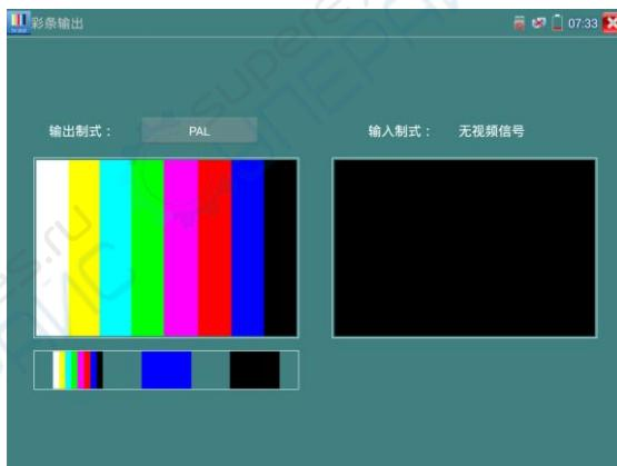
用手指向左右滑动或轻触下面的彩条、蓝色、黑色，可选择相应的图像输出；在屏幕上连击两次，全屏显示和输出。
