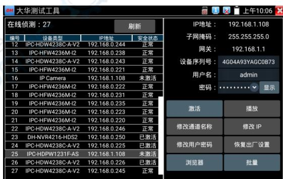
可选“激活”和“批量激活”两种，支持输入重置密码的预留手机号。预留手机号码可以不填。
