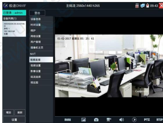
**云台控制：**手指在图像显示区域向左、右、上、下滑动，以及两手指向外滑动扩大、向内缩小，网络球机做相应的转动动作。图像显示区域的左上角，显示云台转动方向。
