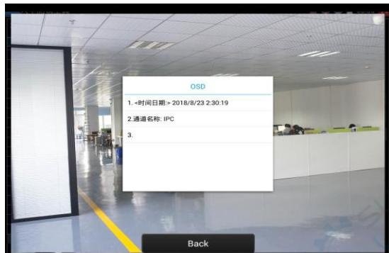
选中通道名称后，可以进行通道名称编辑、显示位置修改和字体大小的切换。“内容位置”选中“默认位置”则不进行修改，选中“自定义”可任意调整通道名称显示位置。点击“确定”后将出现效果图，按键盘返回键或点击屏幕任意区域可返回上一层界面。
