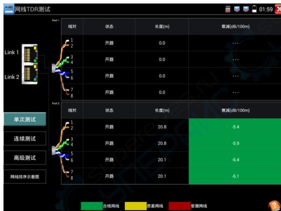
**高级测试:** 测试线缆状态、长度和衰减、反射率、阻抗和时延偏离等参数。
