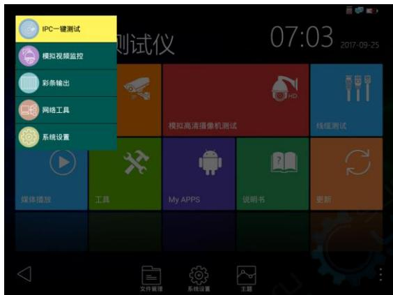
使用键盘中的“菜单键”键 可打开快捷菜单及切换快捷功能，确认键 进入快捷功能。轻触快捷菜单外的其他屏幕区域，可退出菜单。
