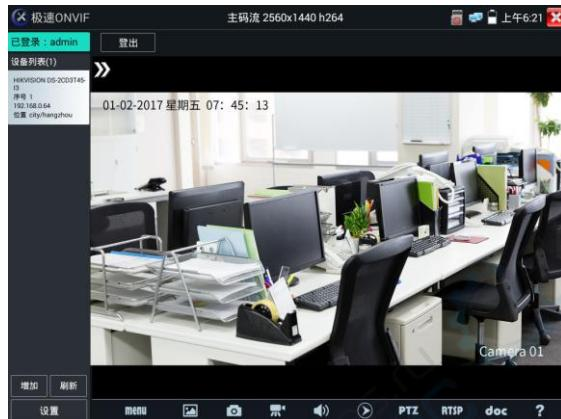
**视频流：**点击“视频流”，可进行网络摄像机的解码分辨率设置，设置后，点击“应用”保存。
