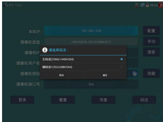
**摄像机IP地址:** 输入IP网络摄像机的IP地址。点击“配置”添加不同网段的IP地址，仪表可测试多网段的网络摄像机。
