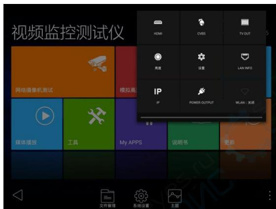
**HDMI:** 开启HDMI输入悬浮窗口，在观看网络摄像机图像时，开启HDMI悬浮窗口，可在观看网络摄像机的同时，观看HDMI输入画面。在任何应用功能界面，都可快速显示HDMI输入图像。
