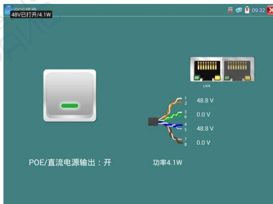
仪表直流电源输出开启，退出电源输出界面后，PoE电源处于开启状态，仪表上面的菜单条一直悬浮“48V已打开”，直到仪表休眠或进入电源输出功能界面点击关闭电源输出。
