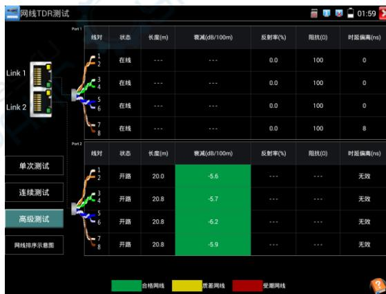
**单次测试：** 测试线缆状态、长度和衰减。
