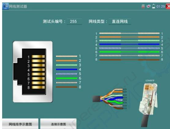
独创 2 芯至 8 芯线路测试，任意两线接通，即可测试显示线序排列、通断情况，以及显示寻线器的编号（默认255）。使用多个不同编号的寻线器，利用测试仪对寻线器编号的读取功能，便于机房线头寻找与排序。
