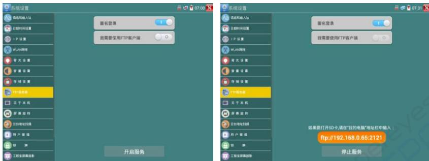
开启FTP服务后，在PC机的“计算机”栏中输入仪表显示的ftp地址（如：`ftp://192.168.0.233:2121`），PC电脑可方便的复制、粘贴文件，而不需要读卡器来读写SD卡文件。
