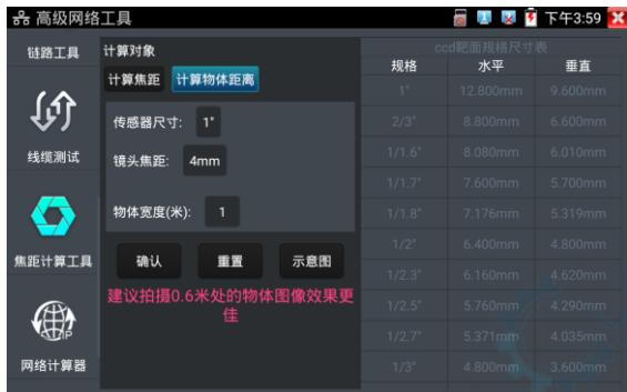
计算焦距：输入传感器尺寸，物体距离和宽度后，点击确认进行计算。
