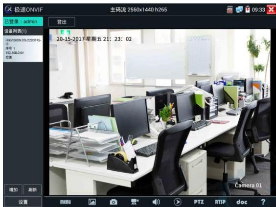
**拍照:** 轻触底部工具栏的“拍照”功能，仪表截取当前显示的图像，并存储于SD卡中。
