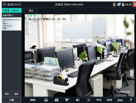
**视频直播：**点击“视频直播”，可直播网络摄像机的图像。双击图像显示区域，仪表全屏显示图像；全屏显示时，双击屏幕返回原来状态。
