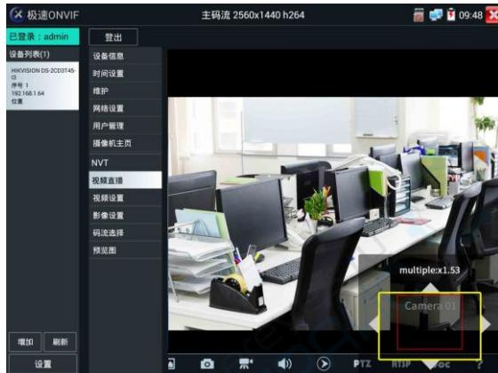
图像放大状态时，如果不用触摸操作，也可按键操作。按
