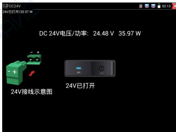
仪表直流24V电源输出开启，退出“DC 24V”界面后，24V电源处于开启状态，仪表悬浮窗口一直显示“24V已打开”，直到仪表休眠或进入“DC 24V”界面点击关闭电源输出。
