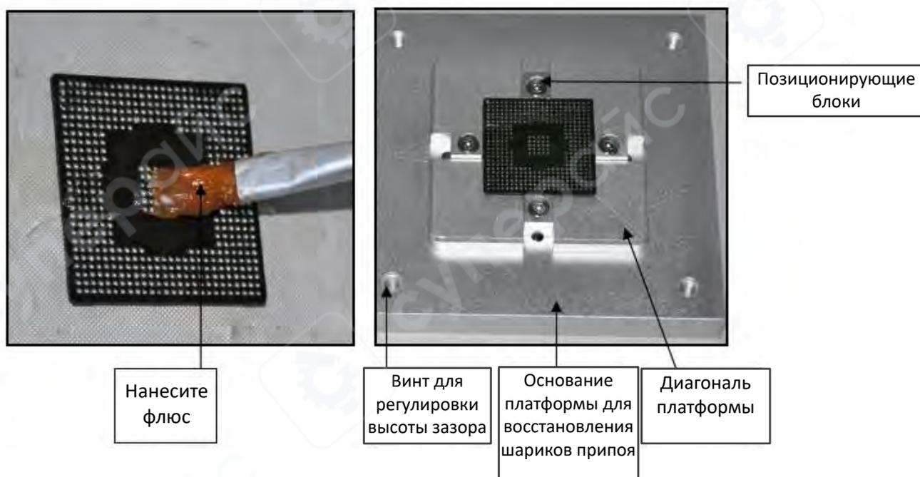
3. Установите рамку с трафаретом для посадки шариков припоя и верхнюю крышку на основание платформы. Затем переместите трафарет таким образом, чтобы его отверстия точно совпали с контактными площадками BGA.
