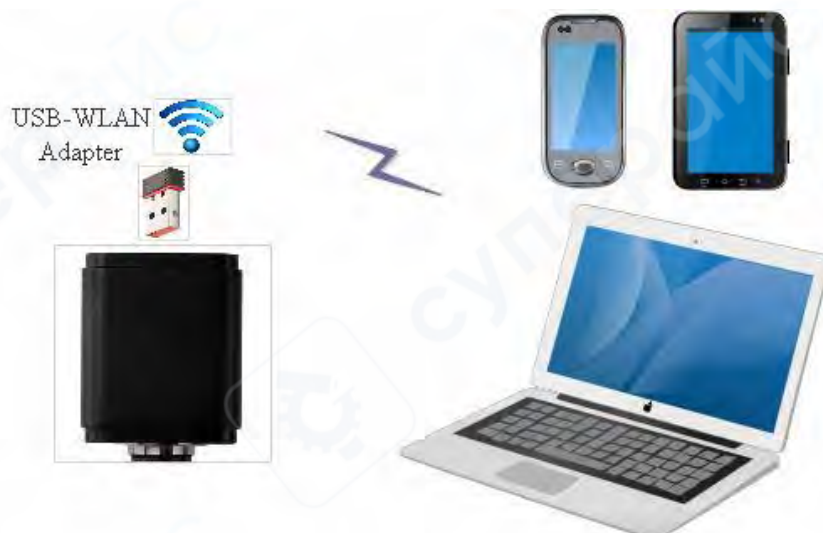
Подключение камеры к ПК, смартфону или планшету по беспроводной сети WLAN
