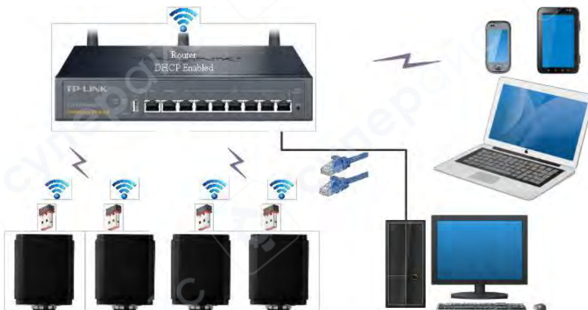
Подключение нескольких камер к маршрутизатору по беспроводной сети WLAN
