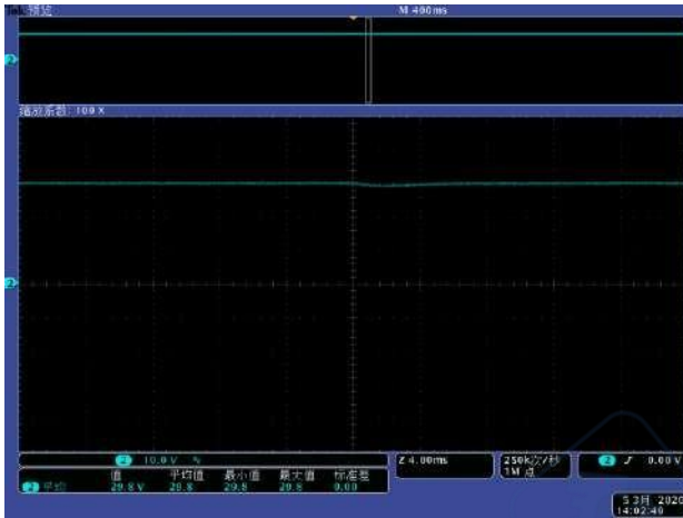
10%到 50%负载变动情况下，动态响应波形
